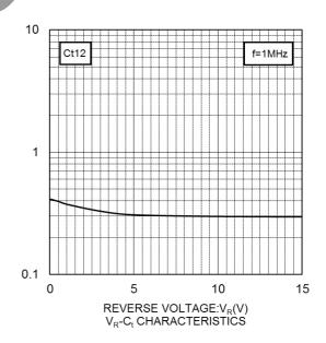
CAPACITANCE BETWEEN TERMINALS:C<sub>f</sub>(pF)
