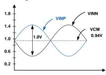
FIGURE 29. ANALOG INPUT RANGE
