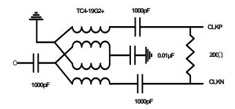
FIGURE 33. RECOMMENDED CLOCK DRIVE
