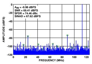
FIGURE 18. SINGLE-TONE SPECTRUM @ 363MHz
