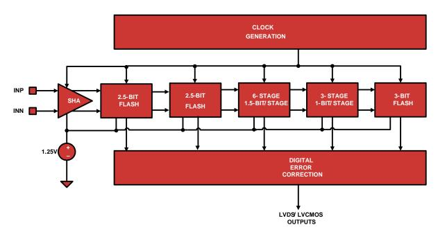
FIGURE 21. A/D CORE BLOCK DIAGRAM
