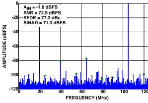
FIGURE 16. SINGLE-TONE SPECTRUM @ 105MHz
