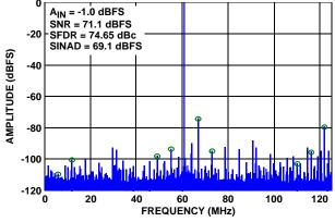
FIGURE 17. SINGLE-TONE SPECTRUM @ 190MHz
